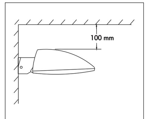
Bei Mastmontage elektrischen Anschluß in der Leuchte vornehmen, Zuleitungskabel durch die Mastbohrung führen und Leuchte in die Wandplatte einhängen.
