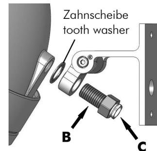
Nach dem Ausrichten der Leuchte Schraube **B** mit 30 Nm anziehen. Zuleitung darf sich nicht mitdrehen. Erst nach dem Anziehen der Schraube **B**, die Druckschraube **C** der Kabelverschraubung dicht anziehen.
