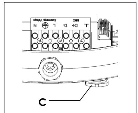
Für die Übertragung des DMX-Signals empfehlen wir ein CAT-5-Kabel 24 bis 26 AWG (Ø 6 mm) mit einem Dämpfungsfaktor von ~110 Ohm.\*\* DMX-Leitung durch die zweite Kabelverschraubung (C) führen, Leitung 6 cm abmanteln und beiliegenden Silikon-schlauch über die Adern ziehen. DMX Anschluss vornehmen und dabei auf korrekten Anschluss der Abschirmung (Masse) an
