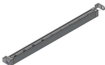
Befestigungsbohrungen für Verbindungswinkel/-ausleger zur Verbindung von zwei Leuchten anzeichnen und bohren. Anschrauben mit beigefügtem Befestigungsmaterial. Verbindungswinkel/-ausleger sollten mit jedem Leuchten-Segment einzeln und der Reihe nach angezeichnet und gebohrt werden. Auf vorgefertigten Stahlkonstruktionen empfiehlt es sich mit Langlöchern zu arbeiten.
