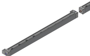
Aufstecken des zweiten/dritten/... Leuchten-Segments SM. Anzeichnen und bohren der Befestigungslöcher für Verbindungswinkel/-ausleger. Anschrauben mit beigefügtem Befestigungsmaterial.
