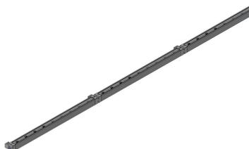
Aufstecken des dritten/letzten Leuchten-Segments SR. Anzeichnen und bohren der Befestigungslöcher für Befestigungswinkel/Wandausleger. Anschrauben mit beigefügtem Befestigungsmaterial.
